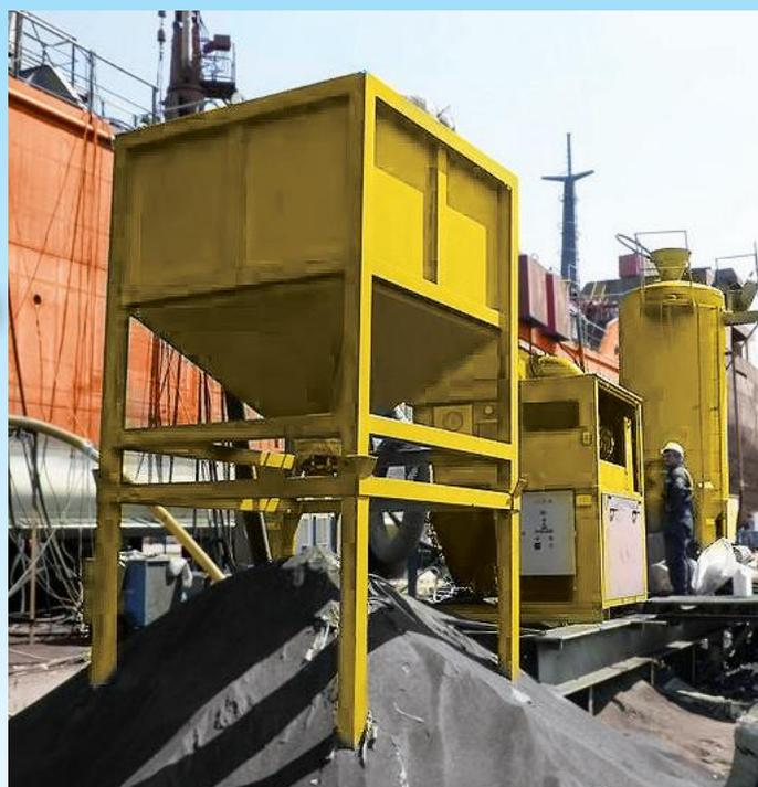
**Les systèmes d'aspiration série VR par NOREXCO®** ont été développés pour répondre aux besoins des applicateurs, afin de retirer l'abrasif utilisé des sites après sablage.
